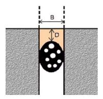
Dans la plupart des cas, une mousse à cellules ouvertes (PU) pourra convenir.
